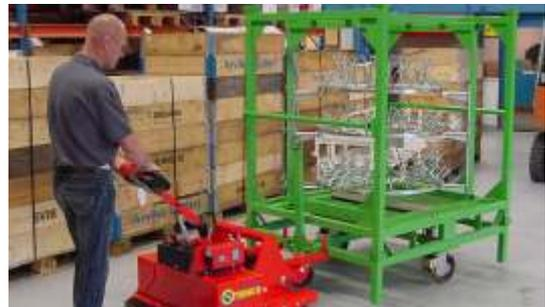
Захват (сцепка) и расцепление от различных тележек выполняется одним нажатием кнопки. Стандартные манипуляторы перемещают тележки массой до 1500 кг. Есть возможность производства манипуляторов для перемещения тележек массой до 3500 кг и более. Возможны установки различных
