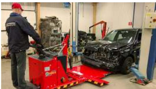
Передняя часть манипулятора имеет армированную панель и стальные прижимные ролики специально разработаны чтобы противостоять острым кромкам деталей автомобиля, которые имеют многие аварийные автомобили.
